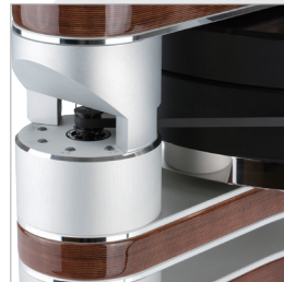
●4 階建て構造としたシャシ。メインプラッターの下にベルト駆動のドライブプラッターを配置。不要共振・共鳴を徹底排除。
