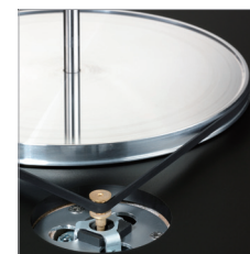
●半独立型ハイトルクモーターを介したベルトドライブによりサブプラッターを駆動。不要なヴァイブレーションを除去。
